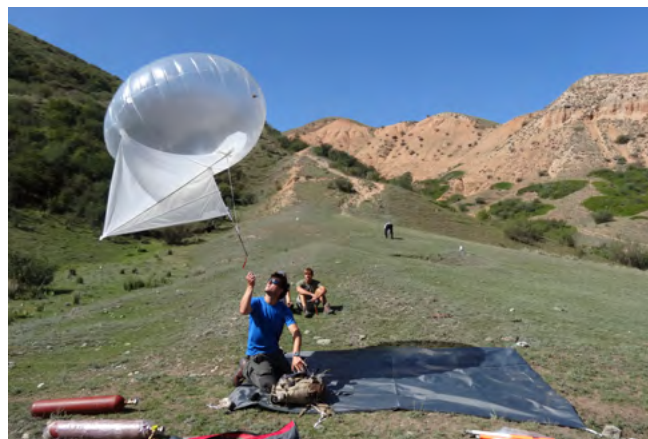
Низковысотная фотограмметрическая съемка с использованием гелиевых шаров в Казахстане. Фото: Ричард Уолкер, 2015
