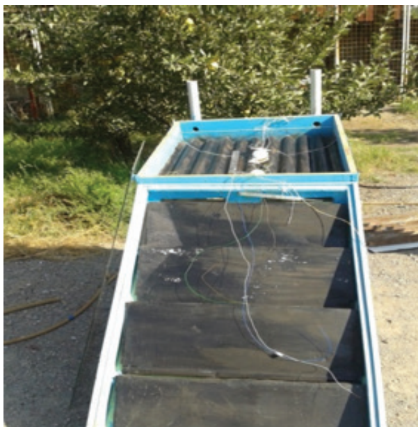
Рис. 7. Сушка продуктов в ССУ «Термика» и открытом воздухе.
