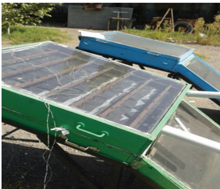
Рис.8. Сушка продуктов в ССУ «Термика» и в ССУ «Индивидуал».
