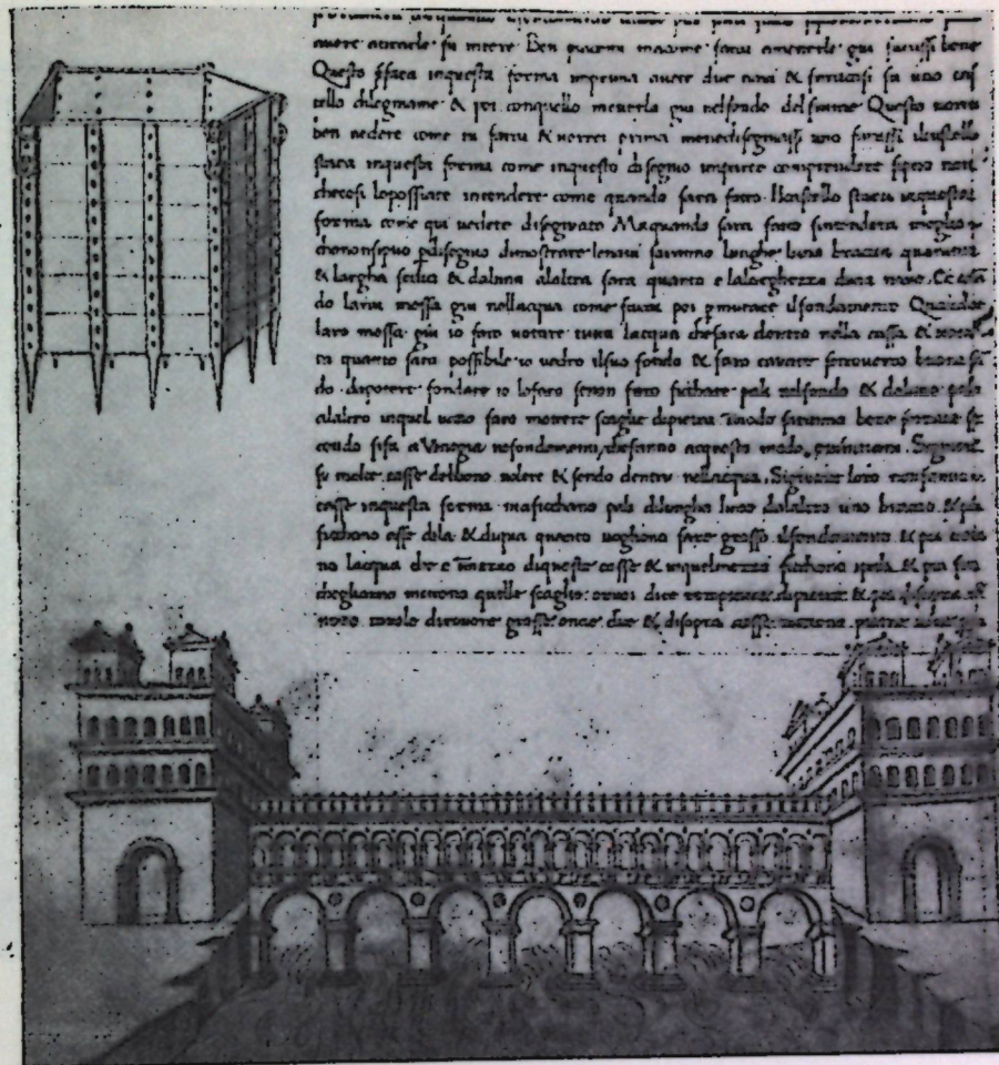
8. Проект двухъярусного моста и опускающей ящик для устройства устоев (F — 94 v)
