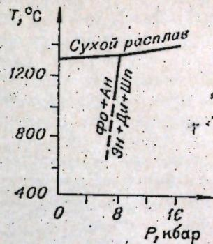
Рис. 6. Линия моновариантного равновесия форстерит+анортит → энстатит+диопсид+спинель в PT-координатах.
