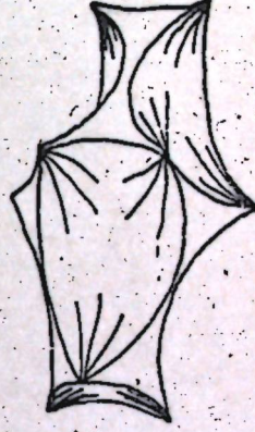
Фиг. 10. Форма поры в отдельном элементе группы наиболее плотно уложенных шаров.
