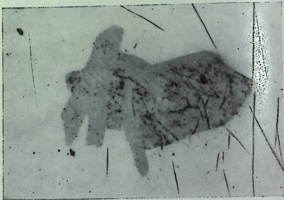
Фото 3. Включение в галените (белое), состоящее из гессита (серовато-белое с черными точками и полосками) и пластинок теллурсодержащего сульфостиммонита серебра № 2 (светло-серые пластинки). Глубина 100 м, \times 1366 .
