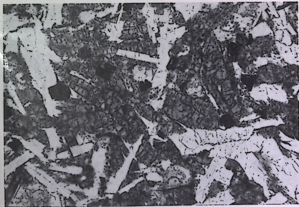
Фото 6. Пироксеновый габбро-диабаз. Призматическозернистая и офитовая структуры. Видны удлиненные призматические клинопироксены, иногда более идиоморфные по отношению к плагиоклазу. Шлиф 992 ж, \times 30 , без анализатора.
