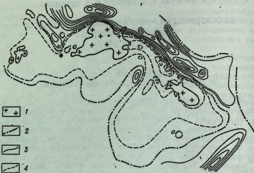
Рис. 2. Схема расположения изолиний магнитного поля над Чалбинским плутоном
