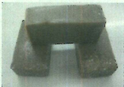
3.10.1.-сүрөт - Полимерлерди колдонуу менен даярдалган жемдин формасы.
