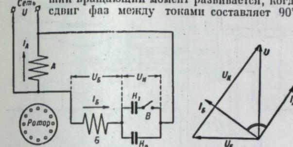
Схема и векторная диаграмма конденсаторного асинхронного двигателя:  $U$  — напряжение сети;  $U_B$  — напряжение на обмотке В;  $U_K$  — напряжение на конденсаторах;  $I_A$  — ток обмотки А;  $I_B$  — ток обмотки В.
