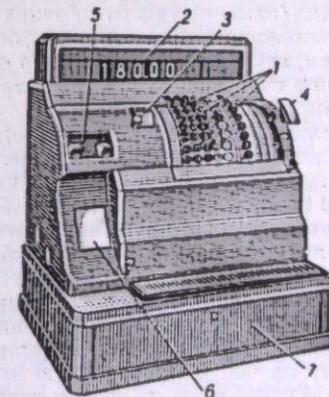
Рис. 1. Клавишный контрольно-кассовый аппарат: 1—клавиши; 2—индикаторы (указатели набранной суммы); 3—суммирующий счётчик; 4—клавиша включения электродвигателя; 5—окно для выхода чека; 6—окно контрольной ленты; 7—денежный ящик.
