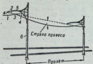
Рис. 1. Простая контактная подвеска на опорах: 1 — контактный провод; 2 — поперечный трос (проволака); 3 и 4 — места расположения изоляторов; 5 — кронштейн (консоль); 6 — опора.
