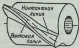
Рис. 1. Контактная линия.
