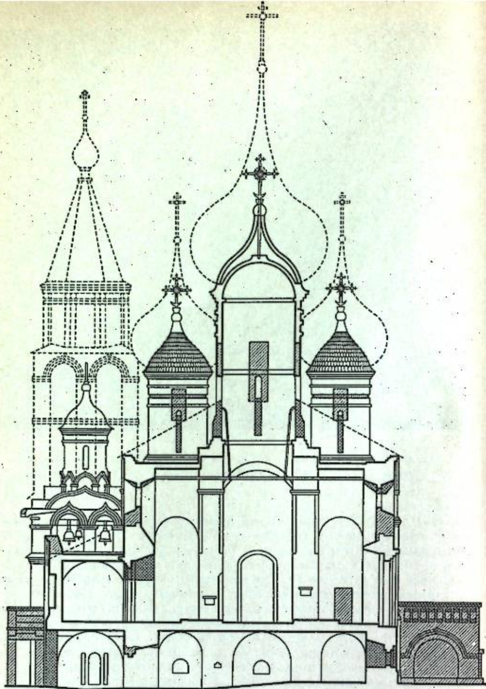
Рис. 47. Богоявленский собор Авраамиева монастыря. Проект реставрации. Поперечный разрез с показом силуэта существующего вида собора
