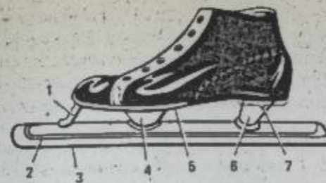
Беговой конек: 1. малая передняя стойка; 2. полоз; 3. лезвие; 4. большая передняя стойка; 5. задняя стойка; 6. передняя платформа; 7. задняя платформа.
