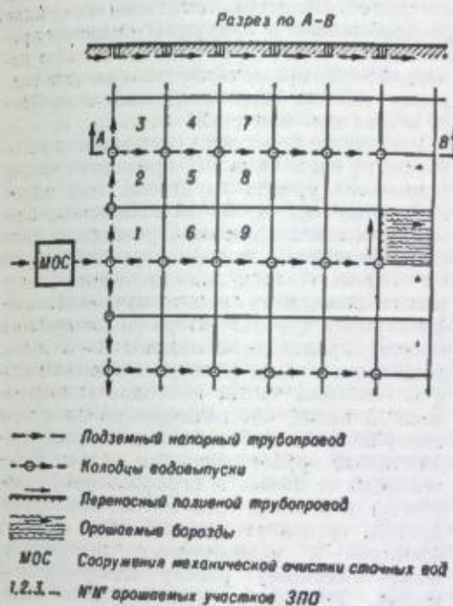
Рис. 2. Технологическая схема земледельческих полей орошения.
