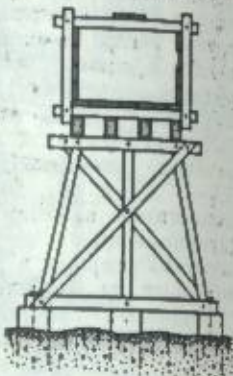
Рис. 1. Деревянный лоток на эстакаде.
