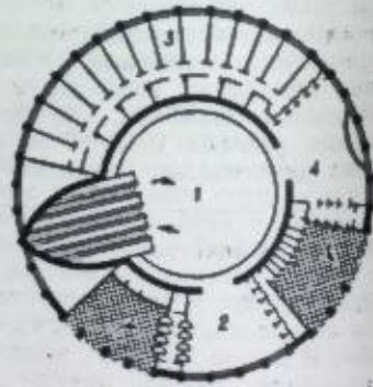
Рис. 1. План 1-го этажа типового наземного вестибюля метрополитена: 1 — эскалаторный зал; 2 — кассовый зал; 3 — служебные помещения; 4 — выходной зал.
