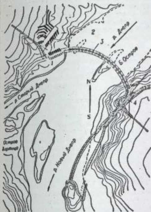
Рис. 1. Гидроузел Днепротэс им. В.И. Ленина: 1 — адание ГЭС; 2 — открытая подстанция; 3 — водосливная плотина; 4 — судоходный шлюз.
