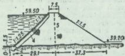
Рис. 2. Каменнонабросная плотина с железобетонным экраном: 1 — экран из железобетонных плит; 2 — бетонный зуб; 3 — цементационные сваи; 4 — подвирванная сухая кладка; 5 — каменная наброска.
