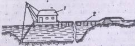
Рис. 2. Землесосный способ работ: 1 — землесосный снаряд; 2 — пульповод.
