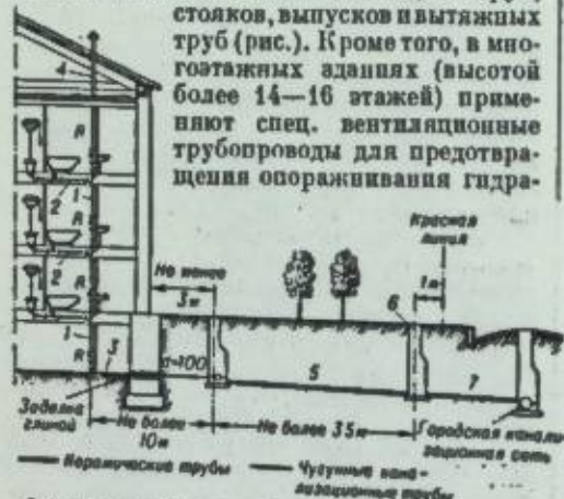
Схема сети внутренней хозяйственно-фекальной канализации: 1 — канализационный стояк; 2 — отводные линии; 3 — выпуск; 4 — вытяжная труба; 5 — дворовая сеть; 6 — контрольный колодец; 7 — соединительная ветка.
