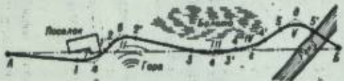
Рис. 1. План участка Ж. д.: I, II, III, IV, V — углы поворота трассы; а, б, в, г, д — вершины углов поворота; 1, 2, 3, 4, 5 — начала кривых; 1', 2', 3', 4', 5' — концы кривых.
