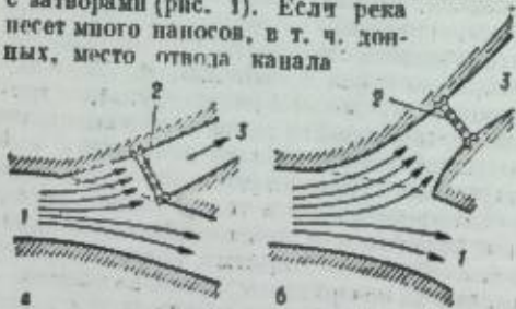
Рис. 1. Схемы бесплотинного открытого водозабора: а — с расположением регулятора на берегу реки; б — с регулятором на канале; 1 — река; 2 — регулятор (водозабор); 3 — канал.
