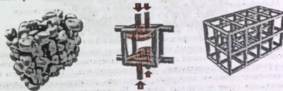
Микроструктура пористой матричной фазы со случайно ориентированными порами, ячейка периодичности по модели Гибсона и Эшби, разработанная ориентационная модель (слева направо)
