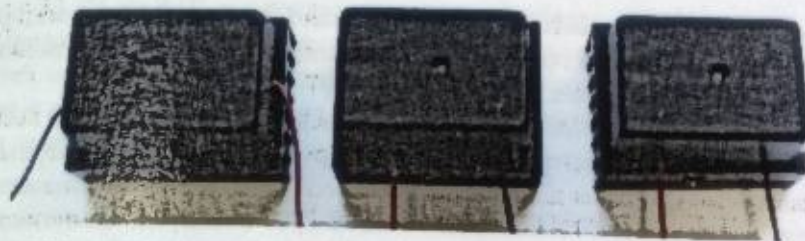
Эталонные высокостабильные источники ультрафиолетового излучения на основе светодиодов (слева направо: от 400 до 315 нм; от 315 до 285 нм; от 285 до 200 нм)
