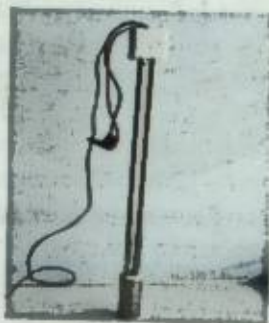
Емкостной двухканальный датчик уровня топлива
