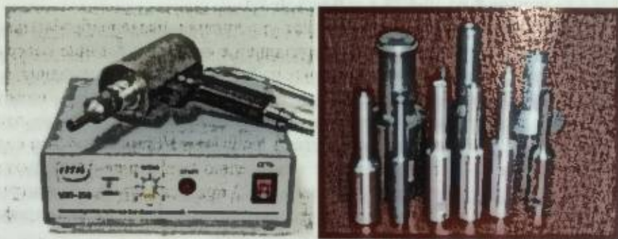
Аппарат для ультразвуковой сварки термопластичных полимеров (слева) и излучатели с различной формой сварочных наконечников (справа)
