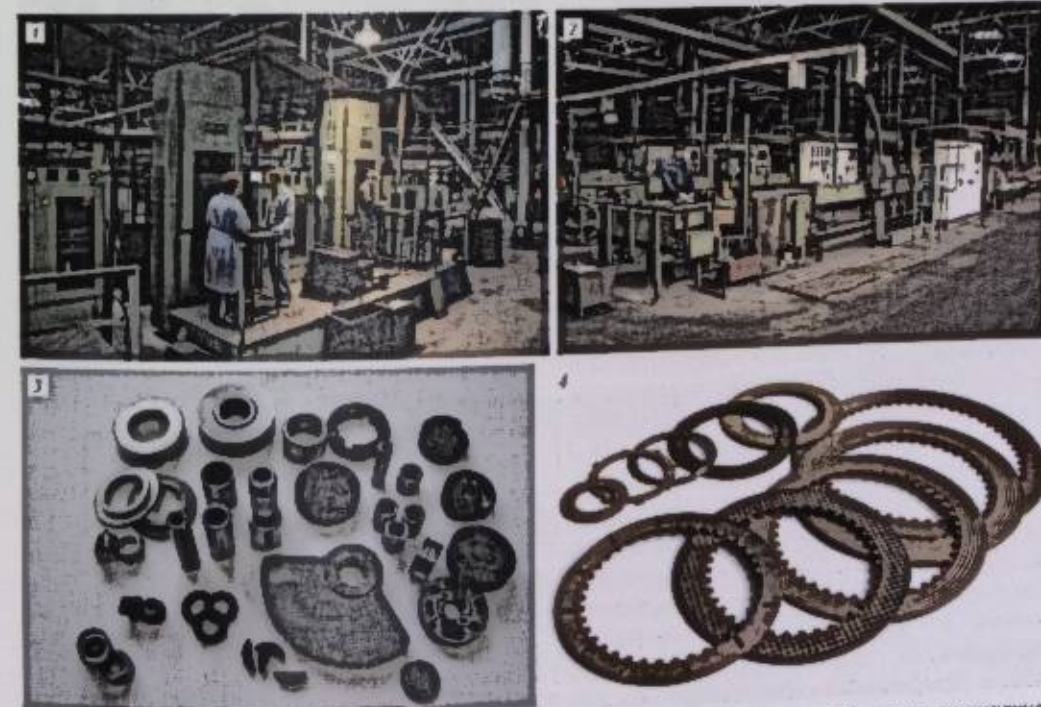
К ст. Молодечненский завод порошковой металлургии: 1 — участок прессования, 2 — участок спекания, 3 — антифрикционные и конструкционные изделия, 4 — фрикционные диски
