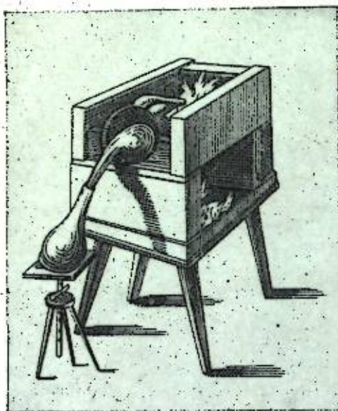
Рис. 2. Горшечная печь ( furnus ollae ) по Тойхмейеру
