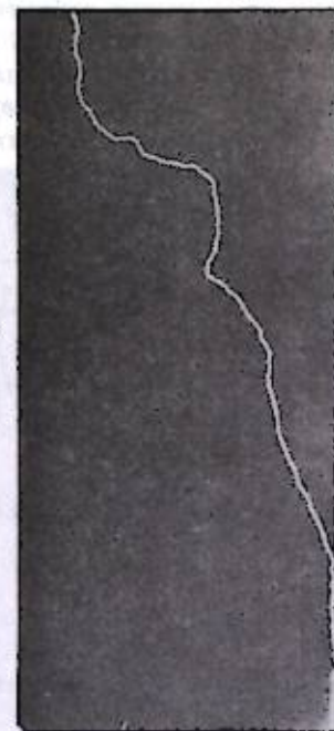
Фиг. 3. Фотография искры, образовавшейся между + стержнем и плоскостью в промежутке, длиной около 6 м
