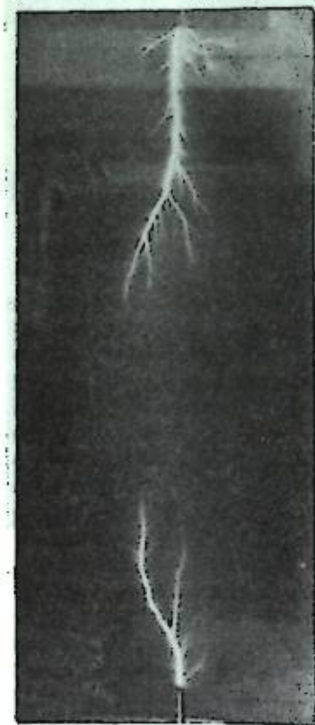
Фиг. 6. Одновременное развитие лидеров в промежутке стержень — стержень
