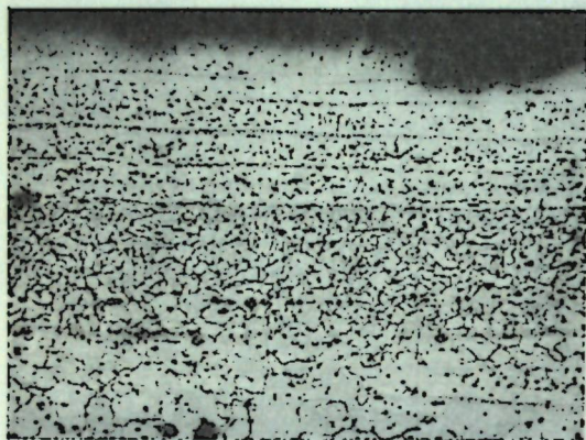
Рис. 7. Структура ножа из городища в Бискупине: феррит с мелким зерном (вверху) и зерно средней величины (внизу)
