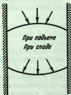
Рис. 5. Направление выпуклости песчаных волн и донных скоростей в опыте Б. А. Аполлова.
