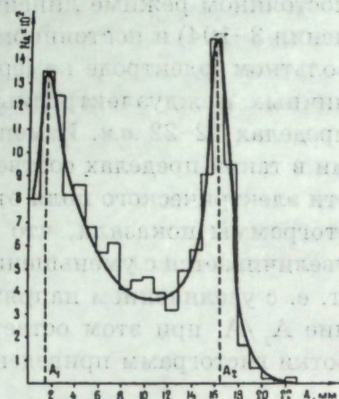
Рис. 6. Гистограмма, полученная при усилении n=3 \cdot 10^5 , междуэлектродном расстоянии R=17 мм и напряжении на высоковольтном электроде V=1000 в.
