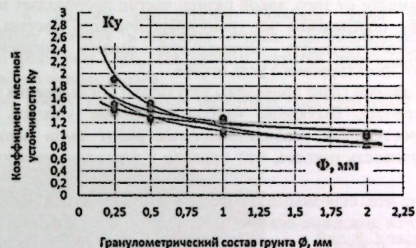
Рис. 6. График зависимости коэффициента местной устойчивости откосов от гранулометрического состава грунтов
