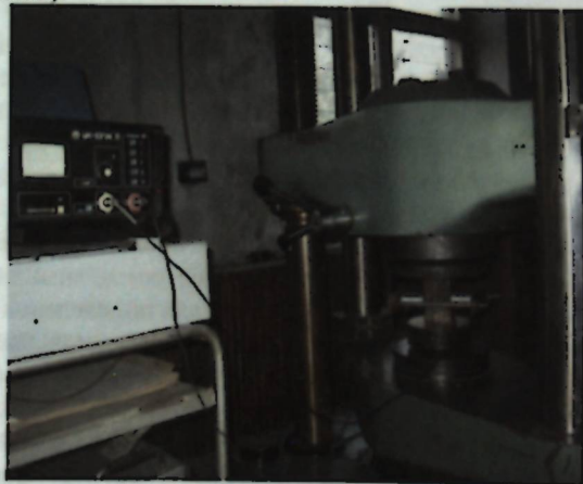
Рис. 5. Нагружение (на прессе ЦДМ-100) и прозвучивание (УК-10 ПМ) призматического образца.
