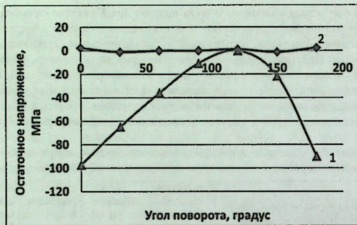
Рис. 6. Графики остаточных напряжений: 1 - метасоматит (рудник Кумтор, проба RS № 5, обр. 3 - 4), 2 - мраморизованный известняк (месторождение Ингичке, обр. 1).
