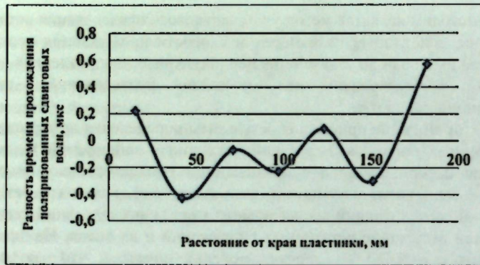
Рис. 2. График разности времени прохождения ультразвуковых сдвиговых поляризованных волн с параллельным (по ширине) и перпендикулярным (по толщине) к длинной стороне пластины вектором поляризации излучателя и приемника (ЭД-6, модель 2-08, после термической обработке).
