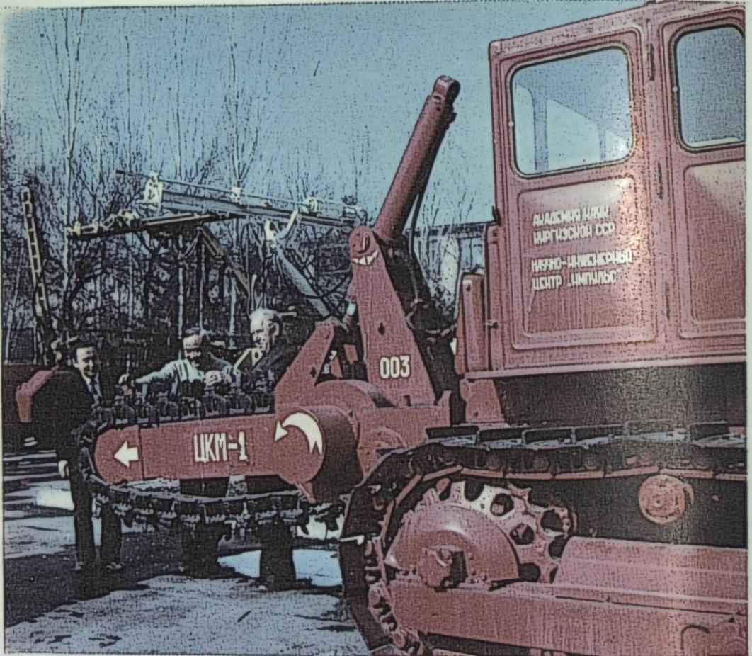
7. Цепная камнерезная машина типа ЦКМ-1
