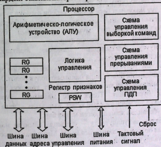
Сүрөт № 7.5 Микропроцессордун ички курамы
