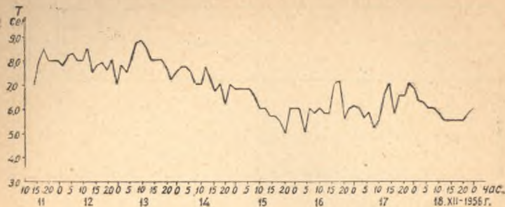
Рис. 2. Изменение периода микросейсм на вертикальной составляющей во время «бури микросейсм» 11—18 декабря 1956 г.
