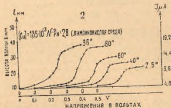
Рис. 6. Полярографирование 1 \cdot 10^{-3} мол. р-ра \text{SnCl}_4 в 5,08 N HCl и 1,85 \cdot 10^{-3} N \text{Cu}(\text{NO}_3)_2 в азотно-лимоннокислой среде при \text{pH}=2,8 . 1) Зависимость i_d от t -ры при электролизе \text{SnCl}_4 . 2) Зависимость i_d от t -ры при электролизе \text{Cu}(\text{NO}_3)_2 .
