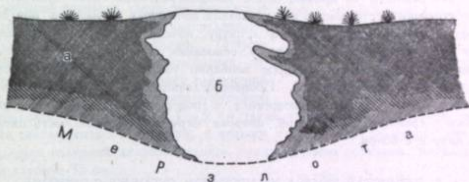
Фиг. 1. Разрез через пятно в кочкарной тундре на глинистых озерных отложениях. а — темный торф, чуть сереющий на границе с пятном и мерзлотой; б — глинистая подпочва, представляющая пятно.
