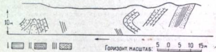
Фиг. 6. Мелкая разнообразная складчатость на р. Бельковской. I — глинистые сланцы; II — песчано-глинистые лежачие сланцы; III — песчаники.
