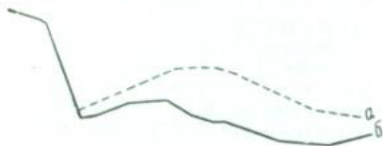
Рис. 1. Схема развития береговой отмели. а — аккумулятивная отмель; б — абразионная ступень.
