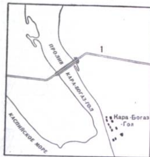
Рис. 6. Схема отделения залива Кара-Богаз-Гол от моря 1 — плотина
