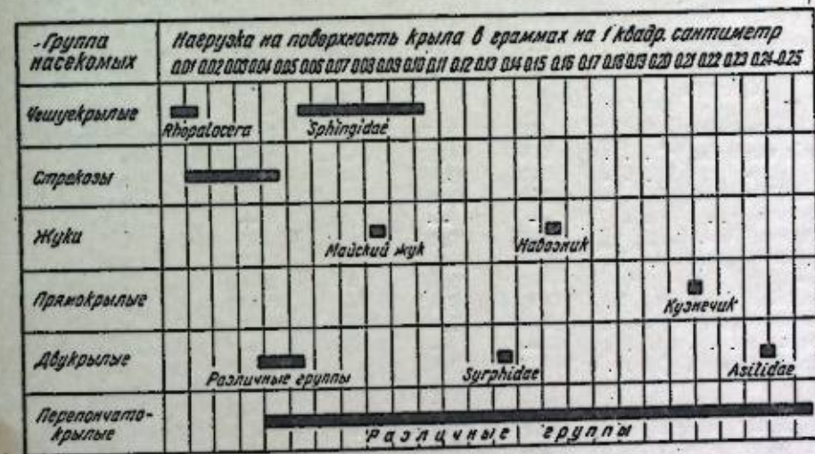
Рис. 18. Распределение насекомых по размерам нагрузки, испытываемой крылом в полете.
