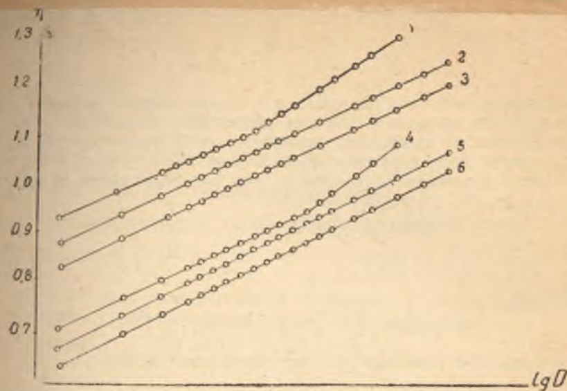
Диаграмма 2. Кривые сравнения перенапряжения на капающем и стационарном ртутном катоде в HCl.
