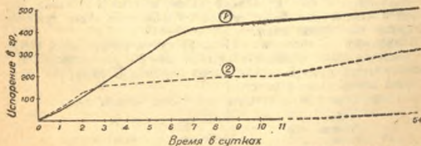
Рис. 2. Суммарное испарение воды песком. Величина зерна 1—2 мм. 1. Песчаная колонна без разрыва капилляров. 2. Песчаная колонна с разрывом капилляров.
