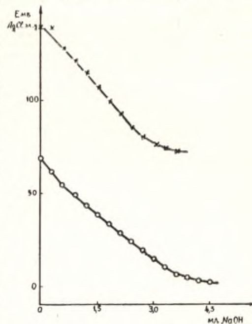
Рис. 5. Титрование раствора 3 н. HCl при наличии 10 н. LiCl и 3 н. HCl раствором едкого натра с хлорсеребряным электродом: O — 3 н. HCl; X — 10 н. LiCl в 3 н. HCl.
