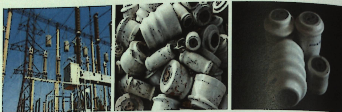
4-сүрөт. Жогорку чыңалуу дагы жаны жана иштетилген изоляторлор
