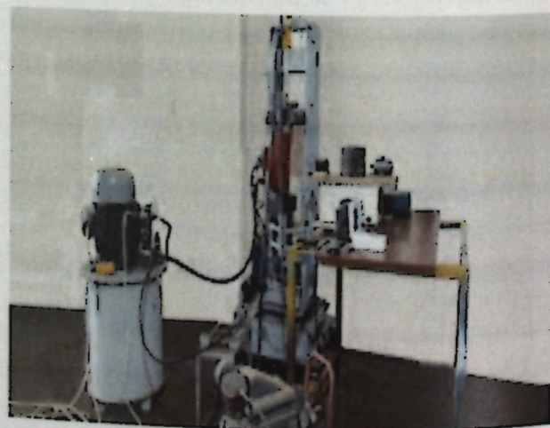
Фото. Испытательный стенд для исследования параметров ручных ударных машин
