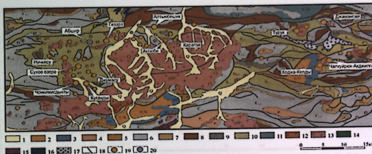
Рис. Размещение золоторудных месторождений и рудопроявлений (желтые кружки) в ореоле и внутри Караказыкской интрузии (розовое)
