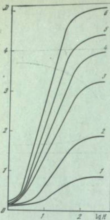
Рис. 4. Характеристические кривые исходного серебряного изображения на фотографической пленке (1), а также изображений, полученных усилением рельефного изображения серебром (2), цветным проявлением (3), никелевым усилением (4), методом КОК (5) и окрашиванием в растворе кислотного красителя (6)
