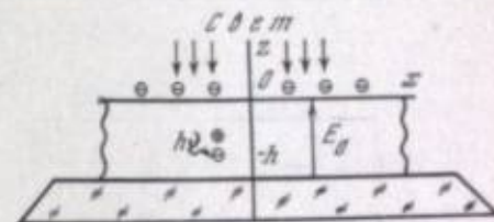
Рис. 1. Схема экспонирования ЭФС и принятая система координат
