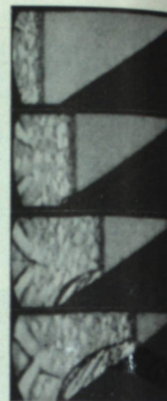
Рис. 4. Нерегулярное отражение детонационной волны.
