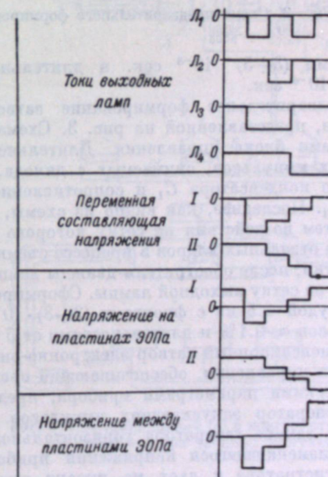
Рис. 2. Скелетная схема выходных каскадов и эюры выходных напряжений и токов.
