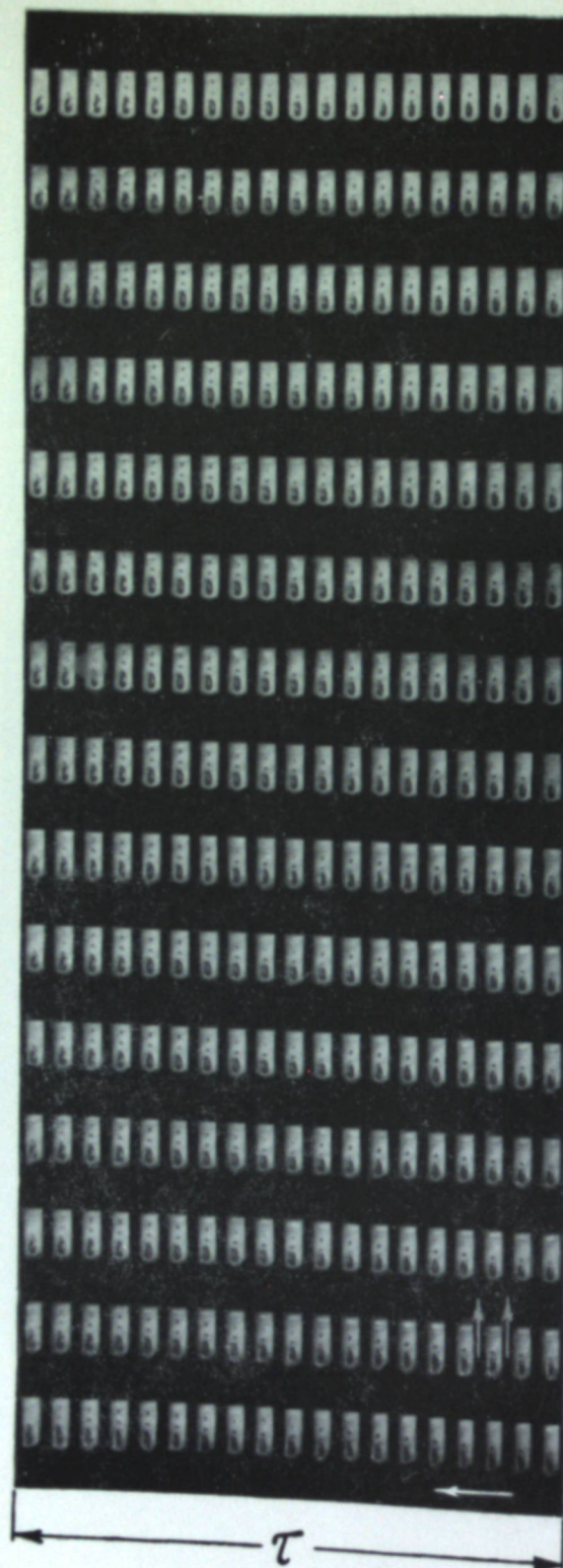
Рис. 4. Участок кинофильма, снятого камерой ССКС-1, \lambda=2.5 , U_0=23 мксек. -1 .
