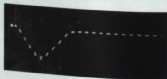
Рис. 8. Осциллограмма светового импульса СФР. Частота съемки 10^6 кадров/сек., метки времени через 0.2 миксек.
