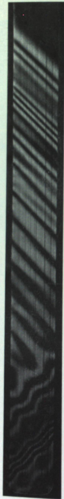
Рис. 3. Кинограмма распространения изохром импульса напряжения в продольном сечении 2/3L , полученная при работе камеры в варианте фоторегистратора.
