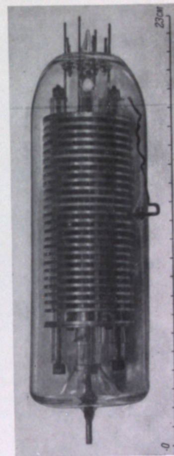
Рис. 4. Многокамерный водородный разрядник.
