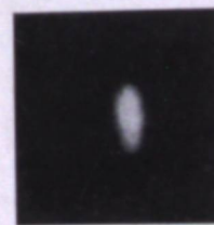
Рис. 2. Фотография изображения «фокусного пятна» бетатрона.
