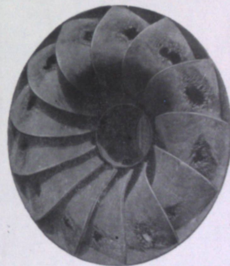
Рис. 1. Очаги кавитационных разрушений на крутообтекаемых лопастях радиально- осевой гидротурбины.
