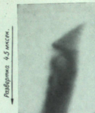
Рис. 2. Линейная развертка начальной стадии свечения мощного импульсного разряда в капилляре.
