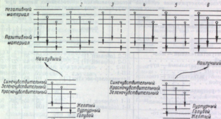
Рис. 1. Возможные варианты строения комплектов многослойных пленок.
