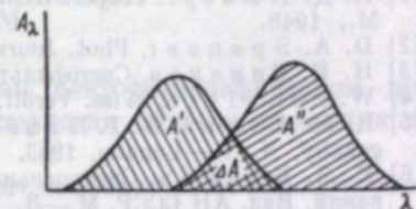
Рис. 5. Схема количественной оценки степени перекрывания спектральных областей светочувствительности элементарных слоев многослойного материала.
