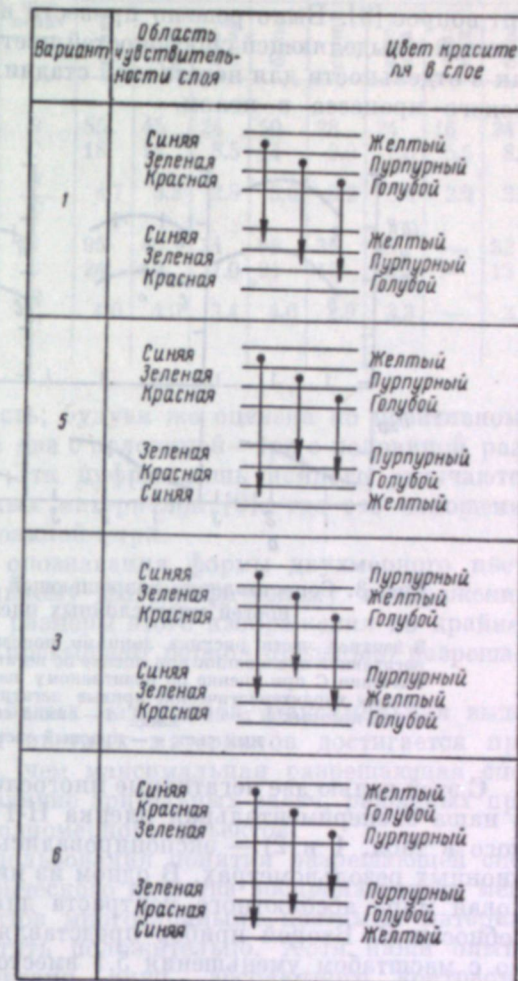
Рис. 2. Строение исследованных комплектов многослойных пленок.
