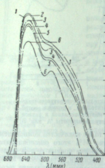
Рис. 9. Кривые поглощения красителя III в эмульсии в присутствии различных количеств компоненты А. Исходная концентрация красителя 192 \cdot 10^{-6} моль/моль AgHal.
