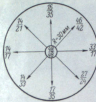
Рис. 5. График изменения разрешающей способности преобразователя ПИМ-3 при отклонении кадра изображения по экрану преобразователя.
