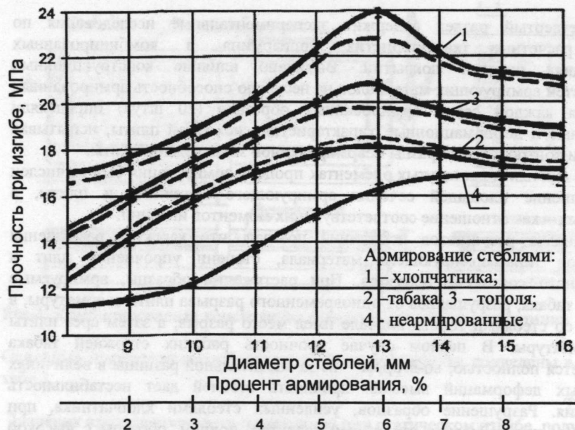
Рис.2. Зависимость прочности плит при изгибе от диаметра стеблей и процента армирования (при плотности полиармина 650 кг/м 3 ).
