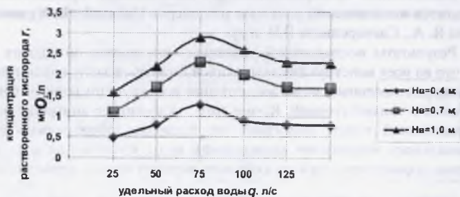
Рис. 4. Зависимости концентрации растворенного кислорода r , мг O_2 /л от удельного расхода воды q , л/с и высоты водослива H_v , м: а) при водосливе с широким порогом; б) при водосливе с тонкой стенкой.
