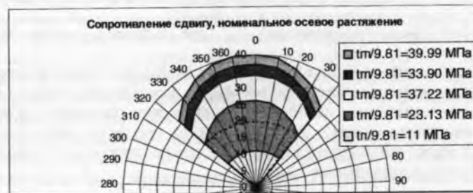
Рис. 14. Динамика развития S_{nl} на главной площадке сдвига после пластического растяжения.
