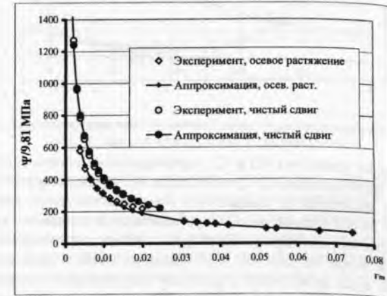
Рис. 2. Сравнительные кривые функции упрочнения \Psi в зависимости от максимальной сдвиговой деформации \Gamma_m для случаев осевого растяжения и чистого сдвига.
