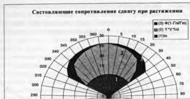
Рис. 13. Картина изменения S_{nl} по различным направлениям в главной плоскости сдвига при растяжении.
