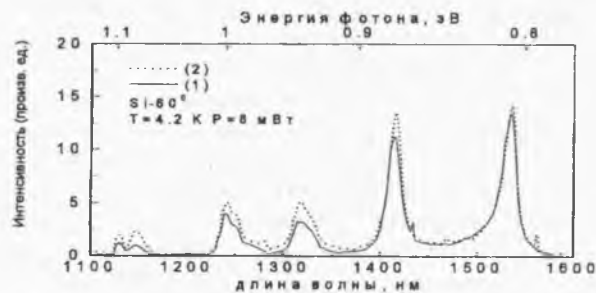
Рис.1 Спектры ФЛ кремния с 60^\circ дислокациями до(1) и после(2) облучения пучком электронов с энергией 300 кэВ. Температура измерения 5 К.
