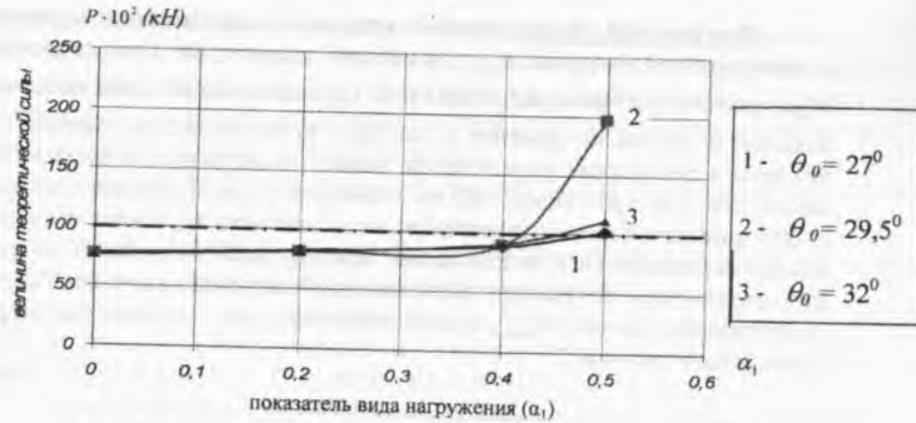
Рис. 8. Зависимость теоретической силы P от показателя вида нагружения \alpha_1 . Нагрузка типа – I P_{\text{эсп.}} = 1 \text{ кН}
