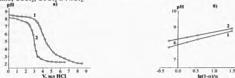
Рисунок 3 - Потенциометрические кривые титрования полимеров ГХАВП (1) и ГХБВП (2) 0,1 N раствором HCl (а) и их обработка по уравнению Гендерсона-Гассельбаха (б)
