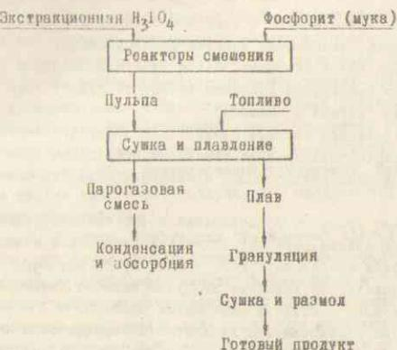
Основным технологическим агрегатом в цепи аппаратов является сушильно-плавильная печь, в которой одновременно протекают процессы сушки и плавления пульпы с непрерывным выпуском плава.
