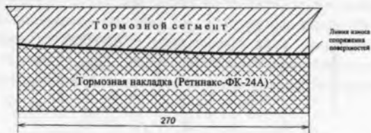
Рис. 15 Профиль износа поверхностей трения тормозного сегмента и тормозной накладки ретинакс ФК-24А гидрогенераторов Токтогульской и Курпсайской ГЭС после реконструкции
