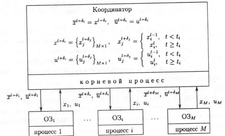
Рис. 1: Параллельная обработка информации в двухуровневой структуре решения оптимизационной задачи.
