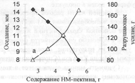
Рис. 11. Влияние концентрации НМ-пектина на его оседание (а) и разрушающее усилие (в).
