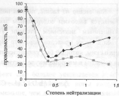
Рис.5. Кондуктометрическое титрование подсолнечной пектиновой кислоты гидроксидами калия (1) и кальция (2).
