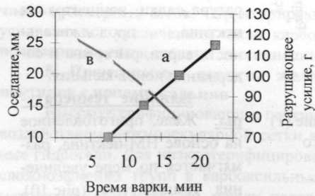
Рис. 12. Влияние времени варки на оседание (а) и разрушающее усилие (в)
