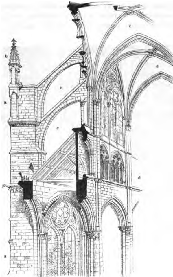
Рис. 46. Система готической постройки (Амьенск. соборъ). а. Опорные столбы, б. Фіалъ, с. Провислая арка, д. Трифорій, е. Крестовый сводъ.
